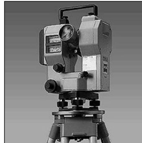
Percebe-se os visores de LCD com os ângulos vertical e horizontal medidos no aparelho
